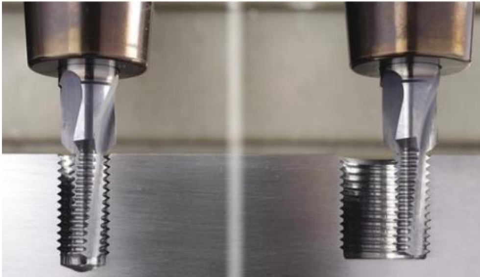
Glodanje unutrašnjeg navoja različitih prečnika istim alatom
